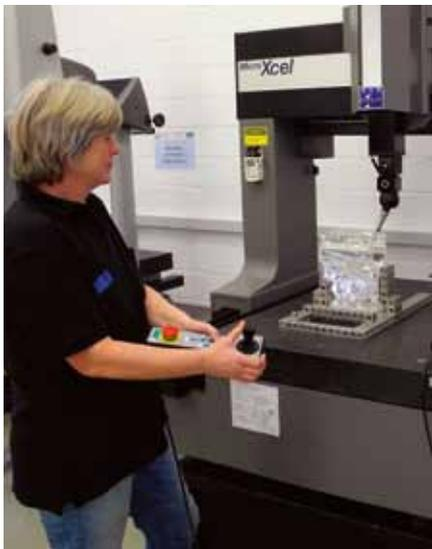
Hochgenaue Vermessung: AMM-Mitarbeiterin Bärbel Gronert an einer 3D Messmaschine. Foto: AMM
